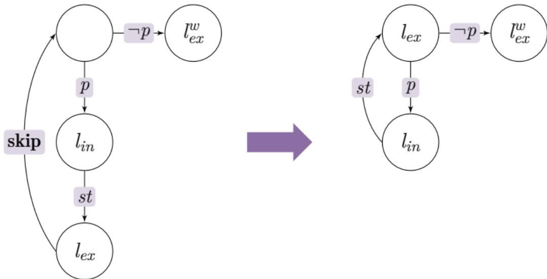
设  $G = (Loc, \Delta, l_{in}, l_{ex})$  为语句  $st$  的控制流自动机, 且  $l_{ex}^w \notin Loc$ , 则 **while** ( $p$ )  $\{st\}$  的控制流自动机为:
