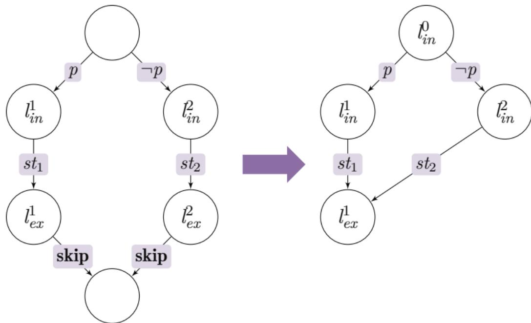
设  $G^1 = (Loc^1, \Delta^1, l_{in}^1, l_{ex}^1)$ ,  $G^2 = (Loc^2, \Delta^2, l_{in}^2, l_{ex}^2)$  分别为语句  $st_1$  和  $st_2$  的控制流自动机, 并且  $Loc^1 \cap Loc^2 = \emptyset$ 。
