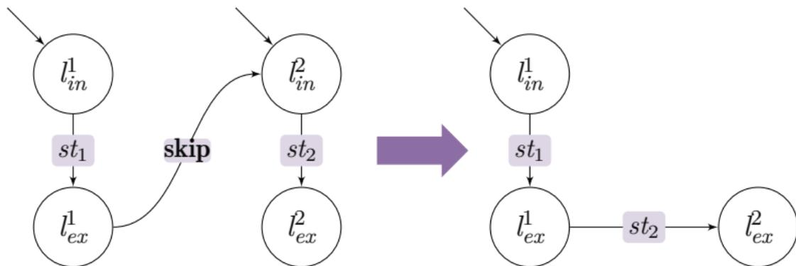
令  $G^1 = (Loc^1, \Delta^1, l_{in}^1, l_{ex}^1)$ ,  $G^2 = (Loc^2, \Delta^2, l_{in}^2, l_{ex}^2)$  分别为语句  $st_1, st_2$  的控制流自动机, 并且  $Loc^1 \cap Loc^2 = \emptyset$
