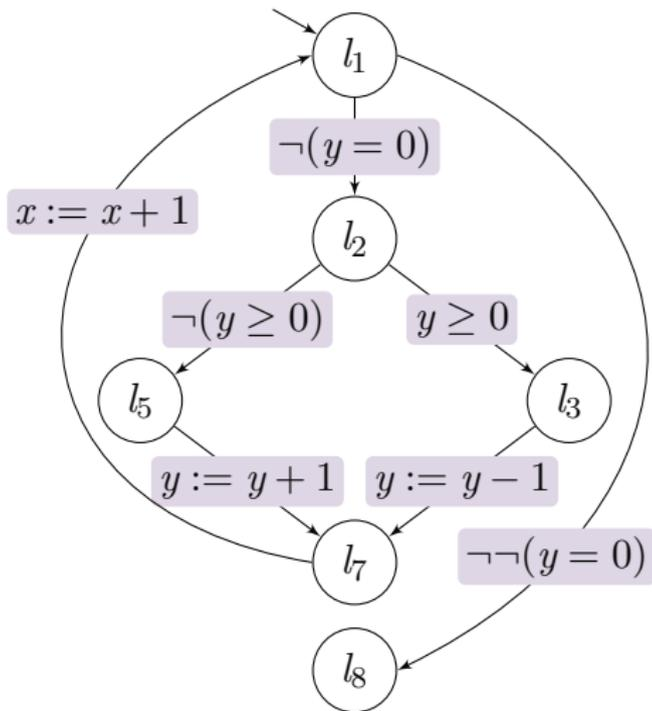
控制流自动机 vs. 控制流图
